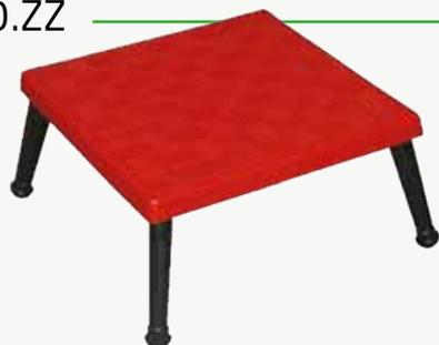
Pedana isolante per interno, in materiale plastico rinforzato con fibre di vetro, piano di cm 50 x 50 spessore mm 4, con superficie antisdrucciolo e 4 gambe in materiale altamente isolante e resistente, avvitabili con una inclinazione atta a rendere la pedana irribaltabile. Isolamento 30.000 V.
