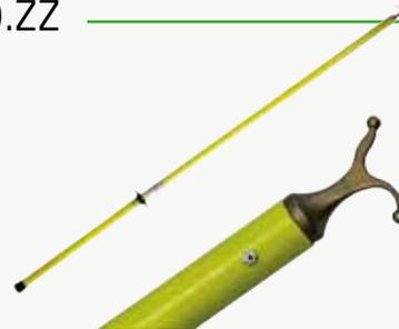
Fioretto isolante, realizzato in tubo di resina poliestere rinforzata con fibre di vetro, lunghezze standard e su richiesta, completo di paramano di delimitazione, gancio di manovra fisso a ricciolo in metallo, lunghezza m 1.50, Ø 32 mm, isolamento 50 KV.
