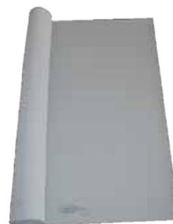
Tappeto isolante in gomma di colore grigio con superficie antiscivolo, collaudati con tensioni di prova a 30.000 Volt, spessore 3mm, tensione di tenuta 40 kVac, tensione di utilizzo 26,5 kVac. Fornibili in altezza cm 100, in spezzoni da 10 metri e multipli. Non propagante la fiamma secondo norma IEC1111.
